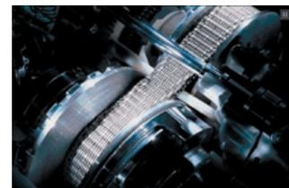
現在入手できる自動車の無段変速機(CVT)は、単にギアを使用するのではなく、ベルトもしくはチェーンでつながった一組の可変径のプーリー(滑車装置)が使用されており、エンジン速度と車輪速度の変速比を無限数生むことができる。
